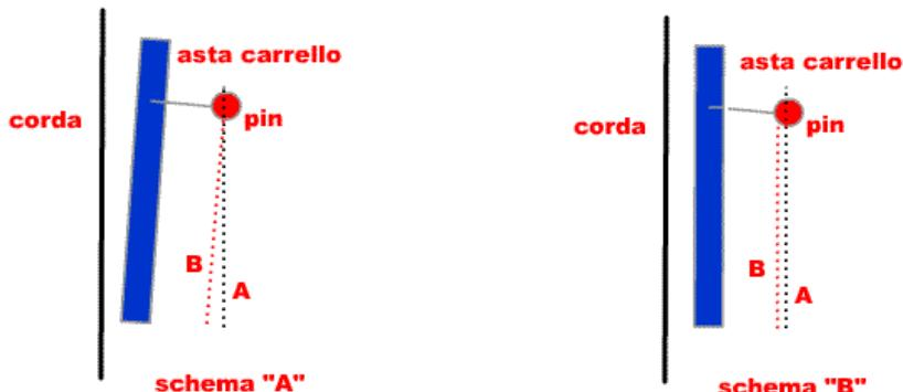
Svitatele per permettere solo, un movimento non libero della barra verticale, trovata la "parallelità" stringete con moderazione e ricontrollate il tutto se risponde a quanto voluto.
